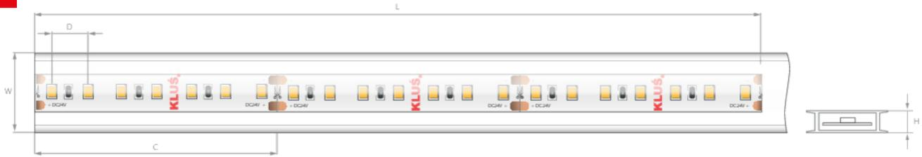
Dimensions: Breite [W]: 16.7 mm | Maximale Stromkabellänge [L]: 10 m | Schnittmöglichkeit je [C]: 50 mm | Abstand zwischen LEDs [D]: 6.25 mm | Höhe [H]: 4.6 mm
