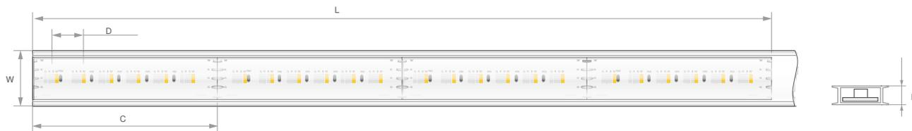
Dimensions: Breite [W]: 12 mm | Maximale Stromkabellänge [L]: 6 m | Schnittmöglichkeit je [C]: 62.5 mm | Abstand zwischen LEDs [D]: 10 mm | Höhe [H]: 4.6 mm
