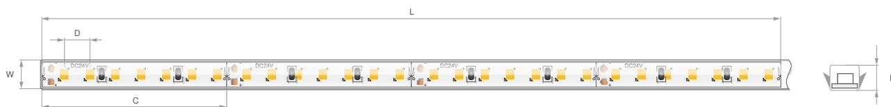
Dimensions: Breite [W]: 7 mm | Maximale Stromkabellänge [L]: 3 m | Schnittmöglichkeit je [C]: 35.7 mm | Abstand zwischen LEDs [D]: 5.1 mm | Höhe [H]: 4 mm
