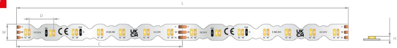
Dimensions: Breite [W]: 7 mm | Maximale Stromkabellänge [L]: 2 m | Schnittmöglichkeit je [C]: 71.42 mm
