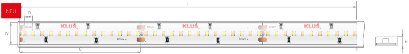
Dimensions: Breite [W]: 12 mm | Maximale Stromkabellänge [L]: 4 m | Schnittmöglichkeit je [C]: 55.56 mm | Abstand zwischen LEDs [D]: 4.2 mm | Höhe [H]: 4 mm
