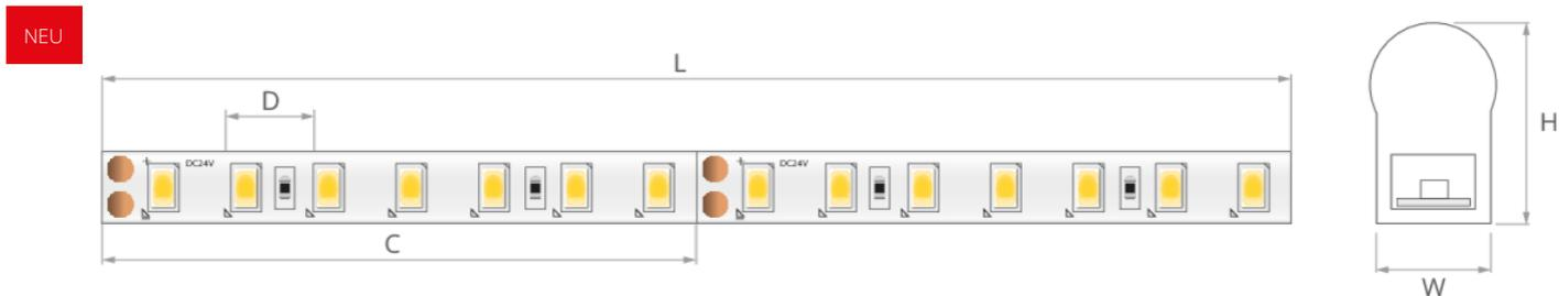
Dimensions: Breite [W]: 5 mm | Maximale Stromkabellänge [L]: 3.5 m | Schnittmöglichkeit je [C]: 38.5 mm | Höhe [H]: 9 mm
