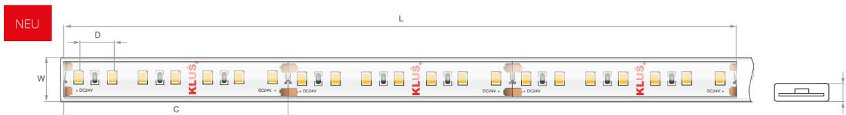
Dimensions: Breite [W]: 10 mm | Maximale Stromkabellänge [L]: 10 m | Schnittmöglichkeit je [C]: 50 mm | Abstand zwischen LEDs [D]: 6.25 mm | Höhe [H]: 4 mm
