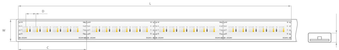
Dimensions: Breite [W]: 12 mm | Maximale Stromkabellänge [L]: 6 m | Schnittmöglichkeit je [C]: 62.5 mm | Abstand zwischen LEDs [D]: 10 mm | Höhe [H]: 4 mm
