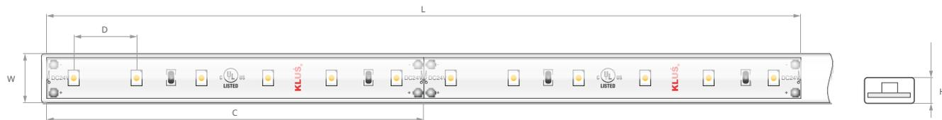
Dimensions: Breite [W]: 10 mm | Maximale Stromkabellänge [L]: 7.3 m | Schnittmöglichkeit je [C]: 100 mm | Abstand zwischen LEDs [D]: 16.7 mm | Höhe [H]: 4 mm
