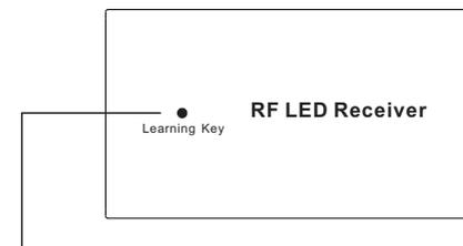
**Schritt 2:** Drücken Sie die "Learning Key" Taste auf dem RF-Empfänger oder schalten Sie den Empfänger wieder ein
