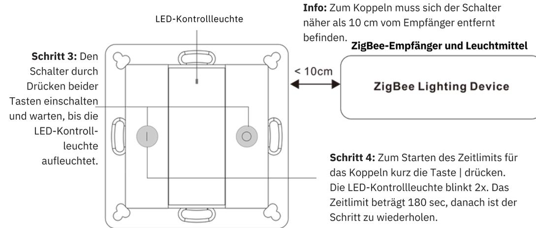
**Info:** Zum Koppeln muss sich der Schalter näher als 10 cm vom Empfänger entfernt befinden.
