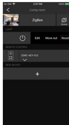
An der Schnittstelle des ZigBee Steuergeräts oder des Hubs die Option Entfernen oder Reset von Leuchten entsprechend den Anweisungen in der App wählen. Als Zeichen des erfolgreichen Resetens blinkt das Licht 3x.
