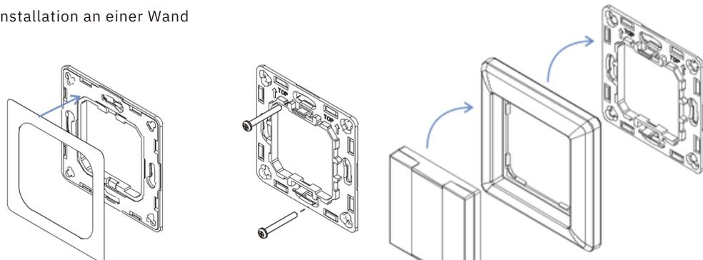
**Methode 1:** Auf der Rückseite der Halterung den 3M Kleber aufbringen und die Halterung an die Wand kleben.
