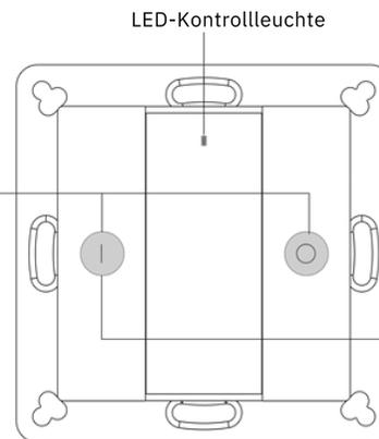
**Schritt 4:** Zur Netzwerksuche sofort die Taste | drücken. Die LED-Kontrollleuchte blinkt jede Sekunde. Das Zeitlimit für das Koppeln beträgt 20 Sekunden. Bei erfolgreichem Koppeln blinkt die LED-Kontrollleuchte 5x.
