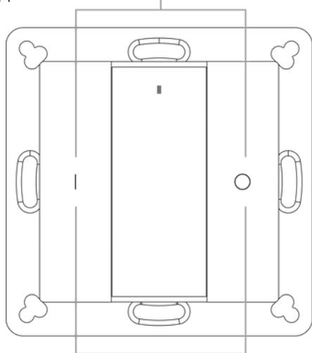
Zurücksetzen auf die Werkseinstellung: beide Tasten 3x drücken. Der Schalter wird unter der Voraussetzung zurückgesetzt, wenn er gekoppelt ist.
